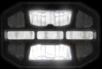
Luce anabbagliante, luce abbagliante, luce di posizione
