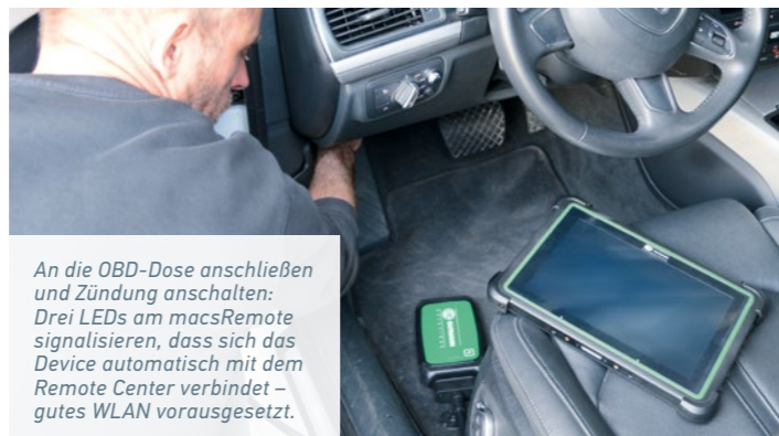
Die digitalen Aktionen an der Fahrzeugelektronik erfolgen aus der Ferne. Der Techniker in der Werkstatt muss nur wenigen Anweisungen folgen.
