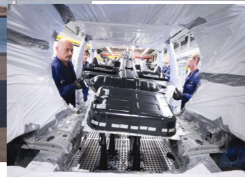
Zwei große 700-Bar-Kunststofftanks mit einer carbonfaser-verstärkten Hülle finden im speziell geformten Unterboden des iX5 Platz.
