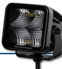
Anbau stehend oder hängend, Multivolt 10 – 30 V, Leistungsaufnahme 40 W, Lichtleistung 3.000 lm, Schutzart IP 68 / IP 69K, ECE-typgeprüft: ECE-R10, Anschluss 500 mm Leitung mit DEUTSCH DT-Verbindung
