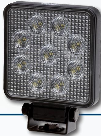
Anbau stehend oder hängend, Multivolt 10–30 V, 9 LEDs, Leistungsaufnahme 9 W, Lichtleistung 1.000 lm, Schutzart IP 6K7 / IP 6K9K, ECE-R10 Zulassung, Anschluss 800 mm Leitung
