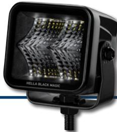
Anbau stehend oder hängend, Multivolt 10 – 30 V, Leistungsaufnahme 20 W, Lichtleistung 1.400 lm, Schutzart IP 68 / IP 69K, ECE-typgeprüft: ECE-R10, Anschluss 500 mm Leitung mit DEUTSCH DT-Verbindung
