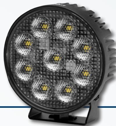
Anbau stehend oder hängend, Multivolt 10 – 30 V, 9 LEDs, Leistungsaufnahme 31 W, Lichtleistung 3.000 lm, Schutzart IP 6K7 / IP 6K9K, ECE-R10 Zulassung, Anschluss 800 mm Leitung Thermomanagementsystem\*\*
