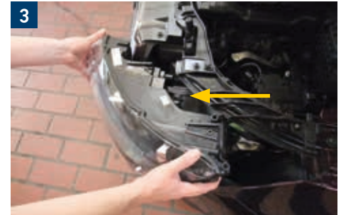
3 → Scheinwerfer vorsichtig nach vorne aus den Führungen schieben und aus der Karosserie nehmen.
