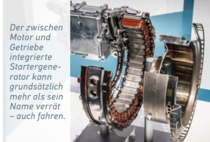
Der zwischen Motor und Getriebe integrierte Startergenerator kann grundsätzlich mehr als sein Name verrät – auch fahren.
