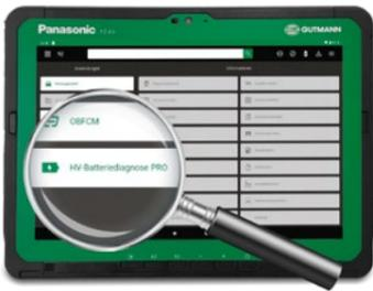
Der Battery Quick Check wird per mega macs-Funktion HV-Batteriediagnose PRO gestartet und läuft in einem durch den TÜV Rheinland zertifizierten Gesamtprozess ohne zeitaufwändiges Fahren ab.
