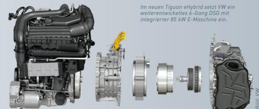
Im neuen Tiguan eHybrid setzt VW ein weiterentwickeltes 6-Gang DSG mit integrierter 85 kW E-Maschine ein.
