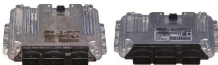
la vettura non si avvia ■ modulo bloccato ■ la valvola egr non funziona correttamente ■ impossibile effettuare l'apprendimento della valvola egr ■ il motore si blocca ■ perdita potenza motore
