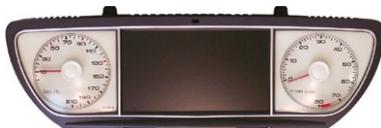
mancato funzionamento ■ illuminazione non funzionante ■ uno o più LED non funzionano correttamente ■ immagine display non corretta ■ errata indicazione velocità ■ errata indicazione del tachimetro ■ errata indicazione livello carburante ■ errata indicazione temperatura ■ errato chilometraggio
