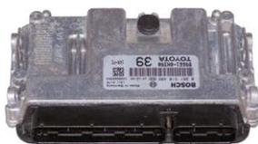
la vettura non si avvia ■ modulo bloccato ■ la valvola egr non funziona correttamente ■ impossibile effettuare l'apprendimento della valvola egr ■ il motore si blocca ■ perdita potenza motore
