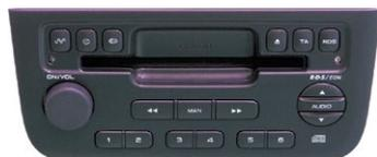
lettore CD non funziona correttamente ■ scarsa ricezione radio ■ uno o più tasti non funzionano ■ mancato avviamento della radio ■ la radio si avvia da sola ■ problemi audio ■ inserimento ed espulsione CD difficoltoso o impossibile
