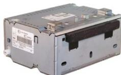
Mancato funzionamento del bluetooth ■ lettore CD non funziona correttamente ■ inserimento ed espulsione CD difficoltoso o impossibile ■ mancato avviamento del sistema ■ problemi audio ■ scarsa ricezione ■ playback USB non funziona correttamente ■ assorbimento anomalo
