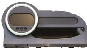
mancato funzionamento ■ illuminazione non funzionante ■ uno o più LED non funzionano correttamente ■ immagine display non corretta ■ errata indicazione velocità ■ errata indicazione del tachimetro ■ errata indicazione livello carburante ■ errata indicazione temperatura ■ errato chilometraggio
