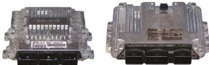
la vettura non si avvia ■ modulo bloccato ■ la valvola egr non funziona correttamente ■ impossibile effettuare l'apprendimento della valvola egr ■ il motore si blocca ■ perdita potenza motore
