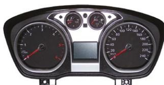
mancato funzionamento ■ illuminazione non funzionante ■ uno o più LED non funzionano correttamente ■ immagine display non corretta ■ errata indicazione velocità ■ errata indicazione del tachimetro ■ errata indicazione livello carburante ■ errata indicazione temperatura ■ errato chilometraggio
