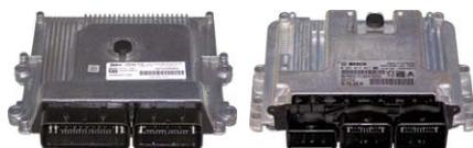
la vettura non si avvia ■ modulo bloccato ■ la valvola egr non funziona correttamente ■ impossibile effettuare l'apprendimento della valvola egr ■ il motore si blocca
