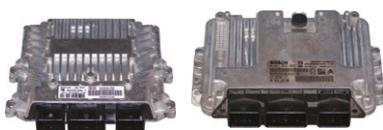
la vettura non si avvia ■ modulo bloccato ■ la valvola egr non funziona correttamente ■ impossibile effettuare l'apprendimento della valvola egr ■ il motore si blocca ■ perdita potenza motore
