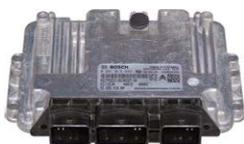
la vettura non si avvia ■ modulo bloccato ■ la valvola egr non funziona correttamente ■ impossibile effettuare l'apprendimento della valvola egr ■ il motore si blocca ■ perdita potenza motore
