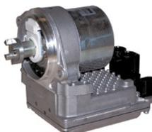
Guasto del servosterzo ■ perdita di assistenza durante le manovre ■ vibrazioni e saltellamenti del volante ■ spia o messaggio d'allerta inerenti al servosterzo → Intervento solo su modelli a 4 denti
