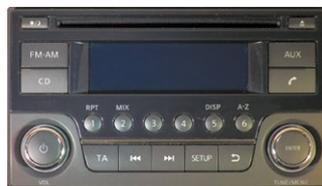
sin visualización o visualización atenuada ■ mala recepción de radio ■ una o más teclas no funcionan ■ no se enciende ■ se enciende de repente aleatoriamente ■ falla audio ■ Inserción y eyección CD difícil o imposible ■ código de radio bloqueado o perdido
