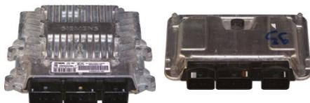
vehículo no arranca ■ calculador bloqueado ■ válvula EGR no funciona correctamente ■ imposible hacer el aprendizaje de la válvula EGR ■ motor se para ■ falta de potencia
