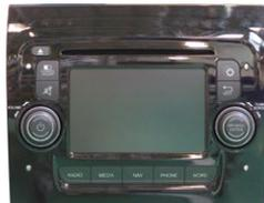
no se enciende ■ aparece el logo y se reinicia ■ se enciende de repente aleatoriamente ■ una o más teclas no funcionan ■ mala recepción de radio ■ no aparece correctamente la cartografía ■ falla audio ■ problema de recepción satélite ■ aparece mensaje de error ■ consumo extraño de corriente ■ pantalla táctil no funciona correctamente ■ lectura CD no funciona correctamente ■ Inserción y eyección CD difícil o imposible ■ código de rádio bloqueado o perdido
