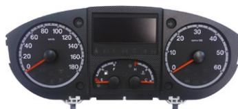
ningún funcionamiento ■ retro iluminación no funciona correctamente ■ uno o más luces no funcionan correctamente ■ visualización incorrecta en pantalla ■ información de la velocidad incorrecta ■ información incorrecta del tacómetro ■ información indicador de combustible incorrecta ■ información indicador de temperatura incorrecta ■ el kilometraje incorrecta
