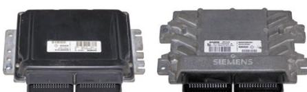
vehículo no arranca ■ calculador bloqueado ■ válvula EGR no funciona correctamente ■ imposible hacer el aprendizaje de la válvula EGR ■ motor se para ■ falta de potencia
