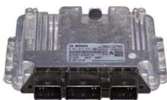
vehículo no arranca ■ calculador bloqueado ■ válvula EGR no funciona correctamente ■ imposible hacer el aprendizaje de la válvula EGR ■ motor se para ■ falta de potencia
