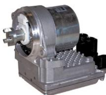
Avería de la dirección asistida ■ pérdida de asistencia durante las maniobras ■ vibraciones y golpes en el volante ■ luz indicadora o mensaje relativo a la dirección asistida -> Intervención únicamente en los modelos de 4 dientes
