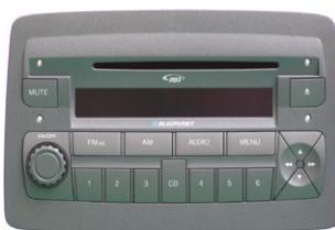
Leitura CD não funciona corretamente ■ má recepção rádio ■ uma ou várias teclas não funcionam ■ não se acende ■ rádio se reinicia sozinho aleatoriamente ■ falha áudio ■ inserção e ejeção CD difícil ou ineficaz
