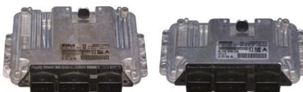
Veículo não arranca ■ calculador bloqueado ■ válvula EGR não funciona corretamente ■ impossível fazer a aprendizagem da válvula EGR ■ motor para ■ veículo falta de potência
