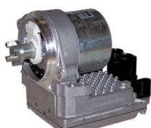
Falha da direcção assistida ■ perda de assistência nas manobras ■ vibrações e solavancos no volante ■ luz ou mensagem de aviso da direcção assistida → intervenção unicamente para modelos de 4 dentes
