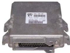
Veículo não arranca ■ calculador bloqueado ■ válvula EGR não funciona corretamente ■ impossível fazer a aprendizagem da válvula EGR ■ motor para ■ veículo falta de potência
