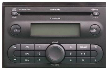
Leitura CD não funciona corretamente ■ má recepção rádio ■ uma ou varias teclas não funcionam ■ não se acende ■ rádio se reinicia sozinho aleatoriamente ■ falha áudio ■ consumo anormal de corrente ■ inserção e ejeção CD difícil ou ineficaz
