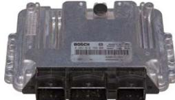
Veículo não arranca ■ calculador bloqueado ■ válvula EGR não funciona corretamente ■ impossível fazer a aprendizagem da válvula EGR ■ motor para ■ veículo falta de potência
