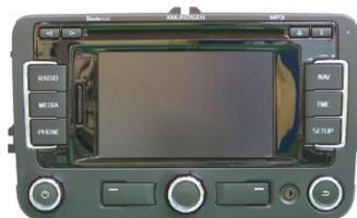
uma ou varias teclas não funcionam ■ má recepção rádio ■ não afixa corretamente a cartografia ■ falha áudio ■ problema de recepção satélite ■ leitura CD não funciona corretamente ■ inserção e ejeção CD difícil ou ineficaz
