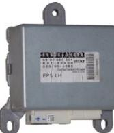
perda de assistência direção permanentemente ■ perda de assistência direção aleatória ■ luz de advertência do motor acesa
