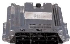
Veículo não arranca ■ calculador bloqueado ■ válvula EGR não funciona corretamente ■ impossível fazer a aprendizagem da válvula EGR ■ motor para ■ veículo falta de potência
