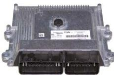
Veículo não arranca ■ calculador bloqueado ■ válvula EGR não funciona correctamente ■ impossível fazer a aprendizagem da válvula EGR ■ motor para ■ veículo falta de potência
