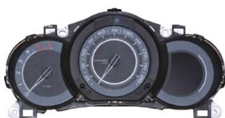
Nenhum funcionamento ■ retro-iluminação não funciona corretamente ■ um ou mais indicador luminoso não funcionam corretamente ■ afixação incorreta sobre ecrã ■ informações de velocidade incorrecta ■ informação tacômetro incorrecta ■ informações indicador de combustível incorrecta ■ informações indicador de temperatura incorrecta ■ quilometragem incorrecta
