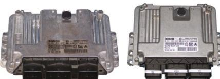
Veículo não arranca ■ calculador bloqueado ■ válvula EGR não funciona correctamente ■ impossível fazer a aprendizagem da válvula EGR ■ motor para ■ veículo falta de potência
