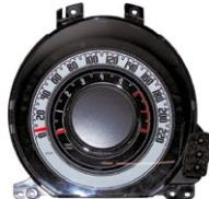
Falha do LCD (ecrã preto ou pixels em falta) ■ luz pouco acesa ■ falha do sinal sonoro ■ velocímetro ou problemas no contador de voltas
