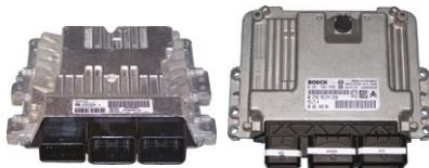
Veículo não arranca ■ calculador bloqueado ■ válvula EGR não funciona corretamente ■ impossível fazer a aprendizagem da válvula EGR ■ motor para ■ veículo falta de potência
