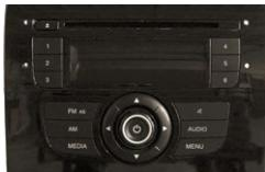
Leitura CD não funciona corretamente ■ má recepção rádio ■ uma ou varias teclas não funcionam ■ não se acende ■ rádio se reinicia sozinho aleatoriamente ■ falha áudio ■ telecomando não funciona corretamente ■ inserção e ejeção CD difícil ou ineficaz ■ código bloqueado ou perdido
