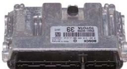
Veículo não arranca ■ calculador bloqueado ■ válvula EGR não funciona corretamente ■ impossível fazer a aprendizagem da válvula EGR ■ motor para ■ veículo falta de potência
