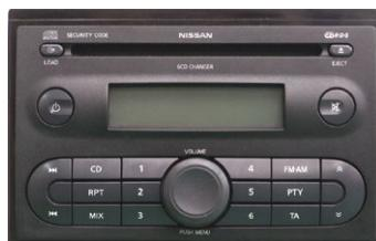
Leitura CD não funciona corretamente ■ má recepção rádio ■ uma ou varias teclas não funcionam ■ não se acende ■ rádio se reinicia sozinho aleatoriamente ■ falha áudio ■ inserção e ejeção CD difícil ou ineficaz
