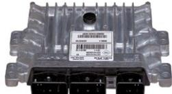
Véículo não arranca ■ calculador bloqueado ■ válvula EGR não funciona corretamente ■ impossível fazer a aprendizagem da válvula EGR ■ motor para ■ veículo falta de potência
