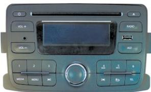
Não se acende ■ rádio se reinicia sozinho aleatoriamente ■ uma ou varias teclas não funcionam ■ má recepção rádio ■ leitura CD não funciona corretamente ■ Bluetooth não funciona corretamente ■ falha áudio ■ consumo anormal de corrente ■ inserção e ejeção CD difícil ou ineficaz
