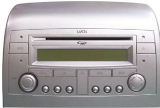
Leitura CD não funciona corretamente ■ má recepção rádio ■ uma ou varias feclas não funcionam ■ não se acende ■ rádio se reinicia sozinho aleatoriamente ■ falha áudio ■ inserção e ejeção CD difícil ou ineficaz
