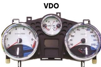
Nenhum funcionamento ■ retro-iluminação não funciona corretamente ■ um ou mais indicador luminoso não funcionam corretamente ■ afixação incorreta sobre ecrã ■ informações de velocidade incorrecta ■ informação tacômetro incorrecta ■ informações indicador de combustível incorrecta ■ informações indicador de temperatura incorrecta ■ quilometragem incorrecta
