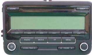
Leitura CD não funciona corretamente ■ má recepção rádio ■ uma ou varias teclas não funcionam ■ falha áudio ■ inserção e ejeção CD difícil ou ineficaz
