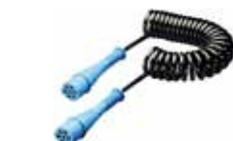
24 V, 7 poli, Lunghezza di lavoro max 4,0 m, con 2 connettori stampati in plastica e protezione anti piega, Uscita cavo a tenuta stagna (IP X9K)
