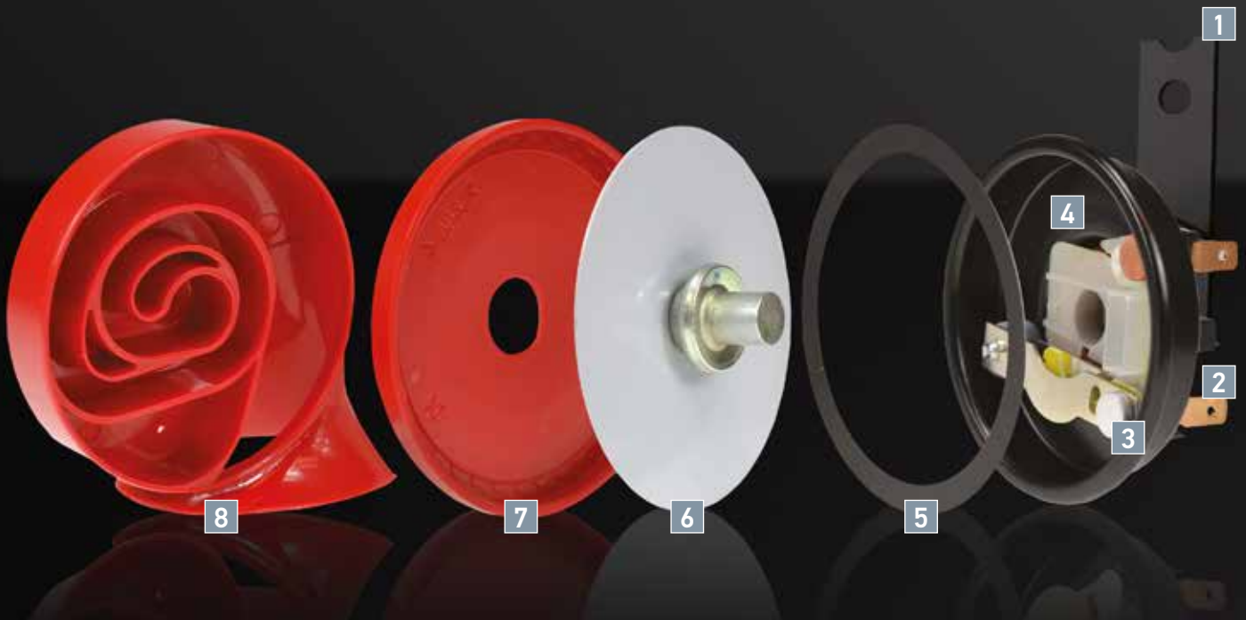
[1] Halter [2] Flachstecker [3] Unterbrecher [4] Magnetspule [5] Dichtung [6] Membrane [7] Dichtscheibe [8] Abdeckgehäuse
