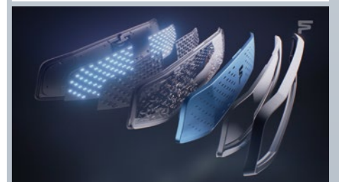
Ein Front Phygital Shield kann aus bis zu acht Schichten bestehen, Beleuchtung und Sensorik integrieren sowie als Radom den Radarsensor schützen.
